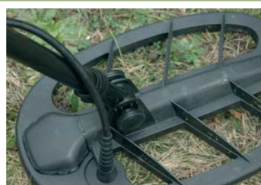
Le disque 27 cm du T 2 est bien de type DD.
