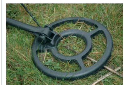
Le disque du DELTA 4000, est de type concentrique/spider et de diamètre 20cm. Il est étanche et ne nécessite pas l'emploi d'un protège disque. En utilisant le PIN-POINT, vous vous apercevrez que la cible se trouve au coeur de la partir éviée au centre du disque comme sur un TESORO Silver.
