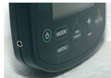
Teknetics a opté pour une prise 3.5mm sur le côté de l'appareil, contrairement à la prise JACK 6.5 mm, idéale pour brancher plus tard un adaptateur pour casque sans fil...
