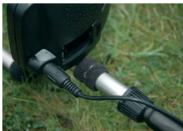
Gros plan sur la fameuse prise DIN qui n'a aucune chance de vous rester dans les mains au moment de la retirer ! On aperçoit aussi la deuxième molette de blocage.
