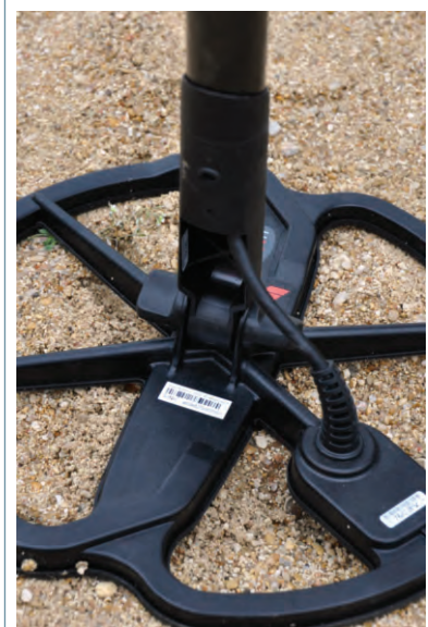
Comme pour les autres «FBS» de la gamme, le câble torsadé passe à l'intérieur de la canne ce qui limite grandement les chances d'une panne de disque due à un arrachement filaire.
