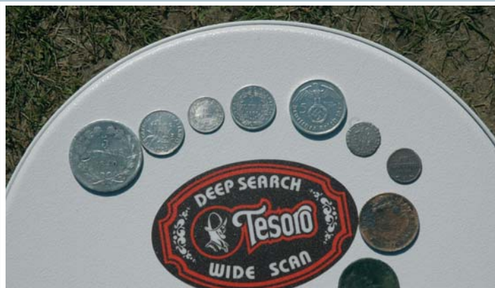
Afin d'augmenter les performances en profondeur, notamment en forêt, vous pouvez équiper votre Compadre Pro d'un disque DD 27 cm. Collection Maxence91.
