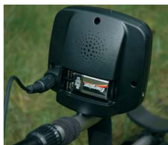
Une seule pile 9V vous donnera aux alentours de 30 heures d'autonomie. Elle s'enfiche facilement dans un compartiment protégé à l'arrière du boîtier. La connectique boîtier est d'excellente qualité puisqu'il s'agit d'une prise DIN composée de 5 contacts qui ne risquent pas de se tordre comme sur d'autres appareils que nous avons pu tester.
