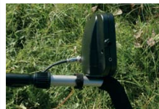
Afin d'éviter les faux-contacts liés aux adaptateurs "JACK", Teknetics équipe ses 2000/4000/6000 et 8000 des deux formats de prise. Ils permettront plus tard par la suite de brancher facilement un casque sans fil...
