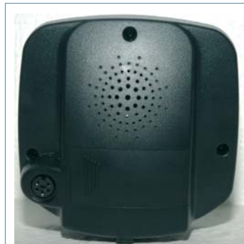
Le haut-parleur se situe à l'arrière du boîtier, ou l'on aperçoit aussi la connectique du casque et le clapet en position fermée du compartiment à pile.
