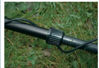
Contrairement à l'ACE 250, les cannes des Teknetics et Tesoro possèdent 2 molettes de blocage qui évitent toute vibration dans la canne au moment du balayage, rendant la détection encore plus confortable.
