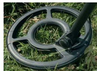
Le disque de l'ALPHA 2000 est de type concentrique/spider et de diamètre 20 cm. Il est étanche et ne nécessite pas l'emploi d'un protège-disque. Avec l'expérience, vous vous apercevrez que la cible se trouve au cœur de la partir évidée au centre du disque comme sur un TESORO Compadre. Le câble arrive sur le disque derrière la vis de serrage. Cet ingénieux choix permet à cette attache d'être protégée de la majeure partie des chocs par la vis.
